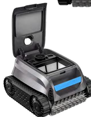
O **Sweepy®** é um robot de limpeza elétrico que possibilita uma limpeza autónoma da sua piscina sem necessidade de ligação ao sistema de filtragem. Liga-se à rede elétrica e recolhe os resíduos na sua própria caixa filtrante. Dotado de uma verdadeira inteligência artificial, acede a todos os cantos da piscina, sobe paredes e limpa a linha de água.
